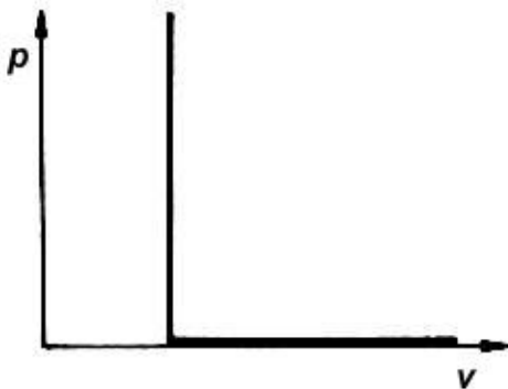
Bild 7: Druck-Volumen-Diagramm des Schmiermittels mit idealer Kavitation
